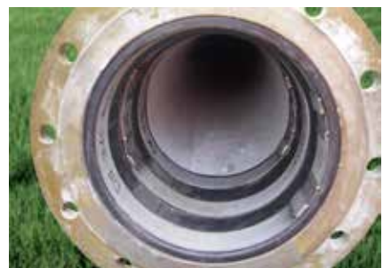
Liner-Endmanschette zur Anbindung in den vor der Installation montierten Flansch bei größeren Rohrdimensionen
