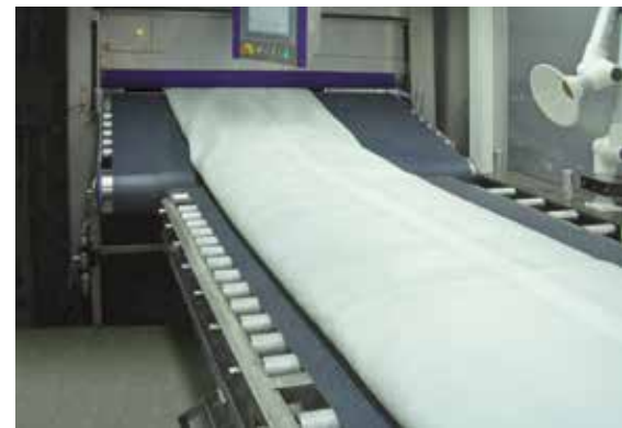
Vor-Ort-Imprägnierung mit Epoxidharzsystem MaxPox®
