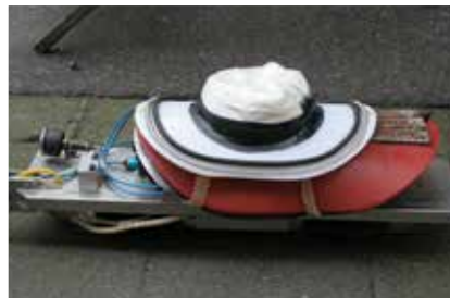
Setzgerät mit Hutprofil für PE-Rohre vor dem Einbau
