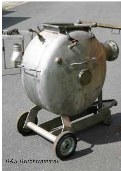
Mobiler Warmwassererzeuger für Sanierungsstrecken mit erschwertem Zugang
